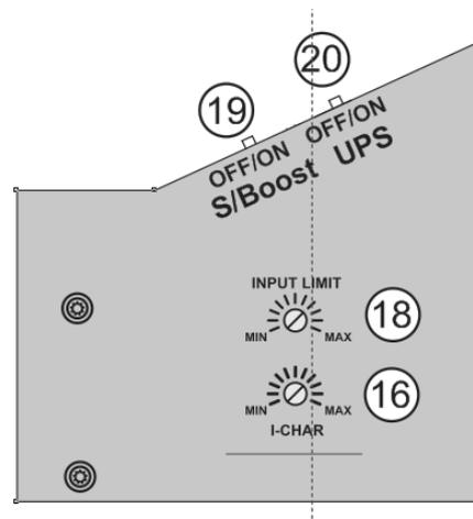
Les réglages faits par ces boutons et potentiomètres peuvent être interdits le paramètre {1551} via la commande à distance RCC-02/03. Ces grandeurs seront alors définies par les paramètres réglés sur la commande à distance. Si le paramètre {1551} est réglé sur "non", les boutons 16, 18, 19 et 20 resteront inactifs même si la commande à distance RCC-02/03 et/ou le module de communication Xcom-232i sont retirés après paramétrage.
