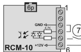
**Pilotage par une tension:** fournir une tension continue ou alternative comprise entre 6 et 60V eff. entre les bornes 4 et 5.
