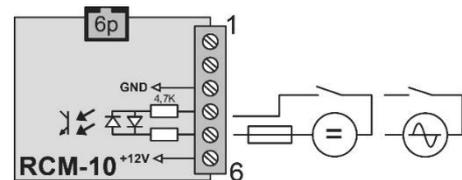
**Note:** sur les modèles XTM et XTS, Il est possible de réaliser cette fonction de pilotage ainsi que la commande marche arrêt principale (voir chap. 9.3.1) sans le module RCM en réalisant le câblage sur la prise (câble) RJ-116P, (RCM-10) tel que ci-contre.
