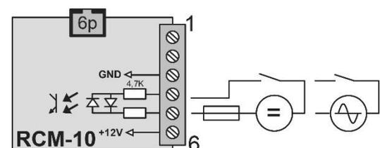
Les bornes 3 à 6 du module RCM-10 sont utilisées comme entrée de commande telle que décrite au chap. 7.7 - p. 33. La fonction dédiée par programmation peut être pilotée par un contact sec (7) entre 5 et 6 avec un pont permanent entre 3 et 4, ou par une tension AC ou DC de max 60 V eff. entre les borne 4 et 5.
