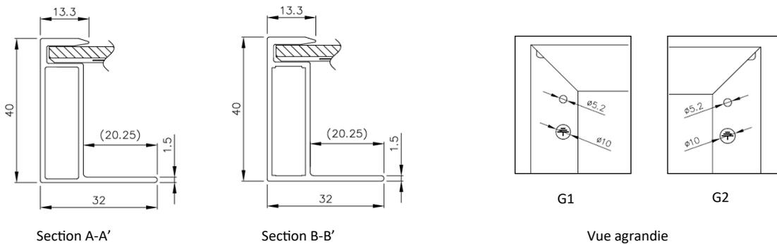
Remarque : un module est installé en utilisant 4 points et un montage symétrique dans les limites de fixation (zone hachurée). Les paramètres des limites de fixation sont indiqués dans le tableau intitulé « Emplacements de montage et résistance de charge ».
