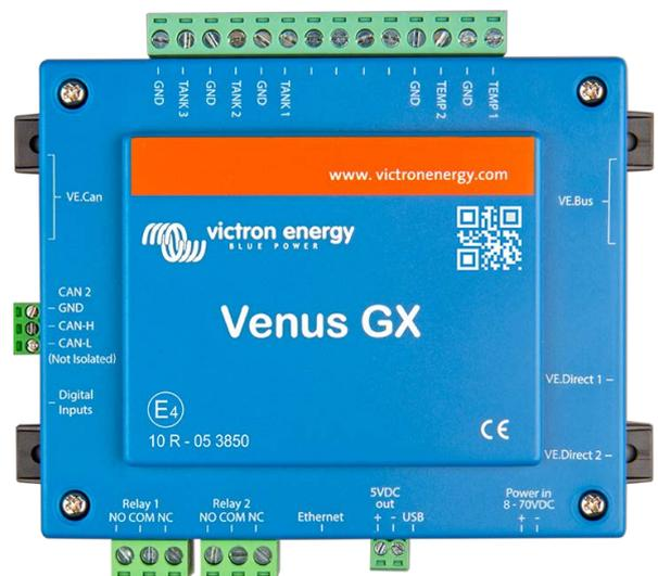
Figure 5 : Connection Venus GX (port VE.CAN sur la gauche, l'autre port non utilisé oit être terminé avec le bouchon bleu fournis).
