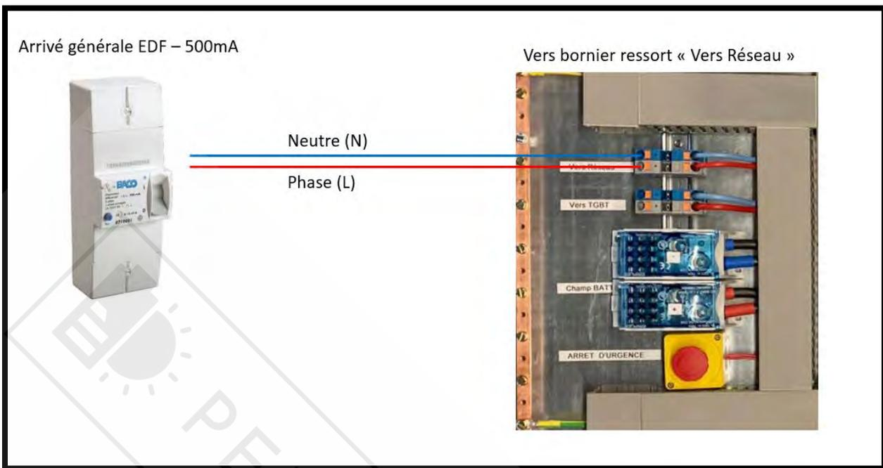
1. Schéma de câblage de l'AGCP vers la platine « bornier *Vers Réseau* »
