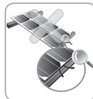
Ne pas rebrancher ou réparer le câble du boîtier de raccordement. Cela peut entraîner des étincelles ou un choc électrique.
