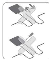
Ne pas plier le câble du boîtier de raccordement. Lorsqu'il est sous tension, cela peut endommager le module. Le rayon de pliage du câble doit être au moins 4 fois supérieur au diamètre du câble.
