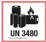
Les batteries lithium-ion sont classifiées en tant que composants dangereux au titre de la réglementation IMDG (UN Class 9 3480). A ce titre, leur **potentiel d'emballage thermique intrinsèque est élevé**, en particulier pour les chimies NMC (TESVOLT), mais dans une moindre mesure aussi pour les chimies LFP (LiFePO4).
