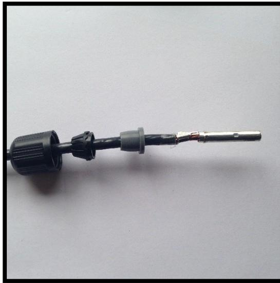
Fig 2. Sertissage réussi d'une cosse solaire.
