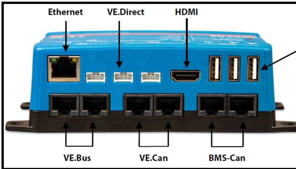
Fig E. Connectique du Cerbo GX (face arrière)
