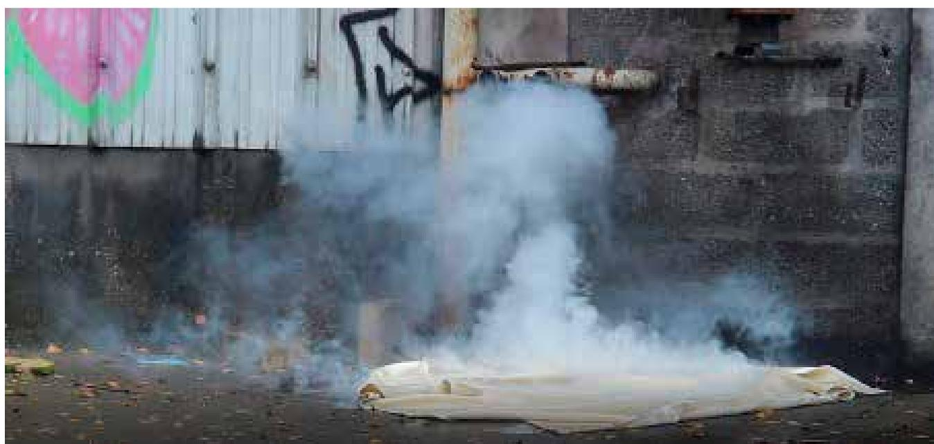
Figure 50 : Fumées blanches froides lors de l'étouffement d'un pack de cellules NMC de
