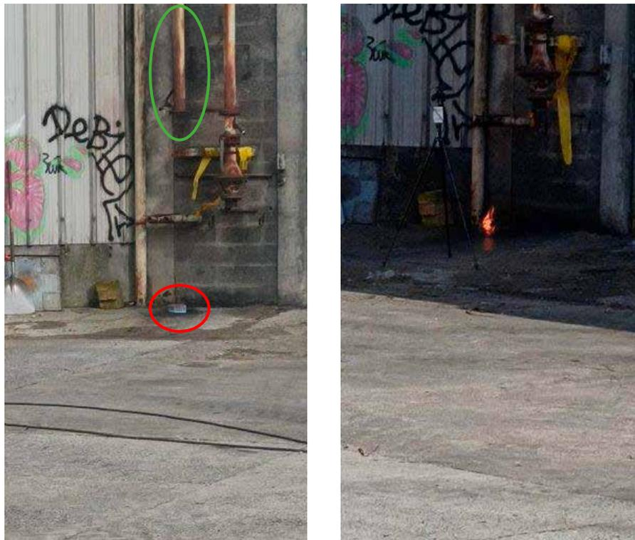
Dispositif mis en place pour tester les batteries quart de lune au choc
