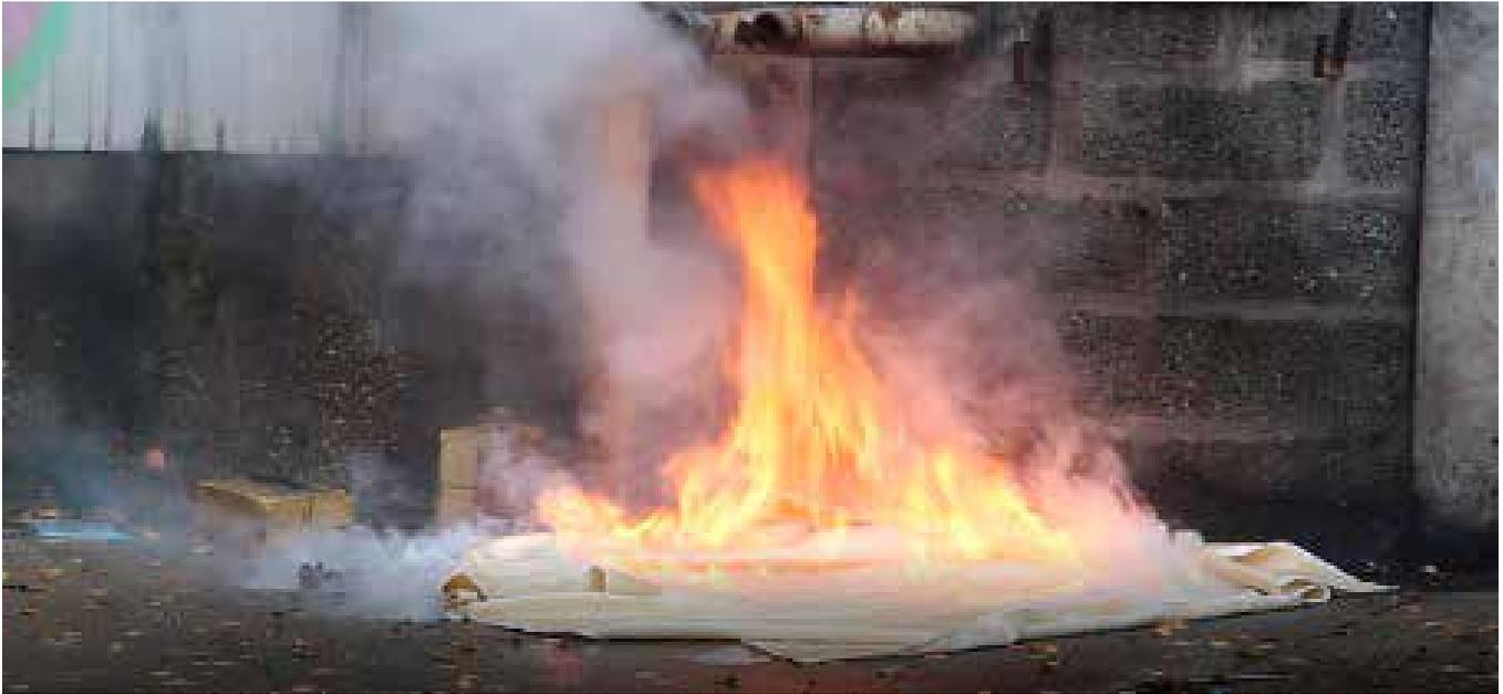
Figure 51 : Inflammation des fumées blanches sur pack NMC de 500Wh.
