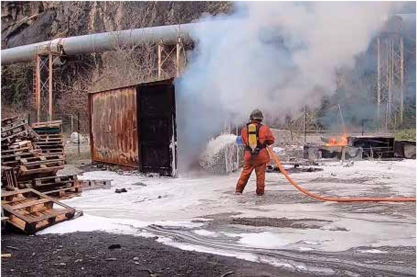
Figure 59 : Utilisation de mousse sur un feu de batterie d'environ 40kWh.
