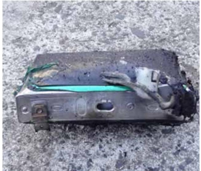
Sur les photos ci-dessus, on voit bien que sous l'augmentation de pression à l'intérieur des cellule le casing de celles-ci s'est déformé. De plus, sur les photos du module, on distingue bien que le casing de celui-ci n'a pas supporté la chaleur et l'augmentation de pression de chaque cellule, il s'est complètement ouvert laissant les cellules se désolidariser les unes
